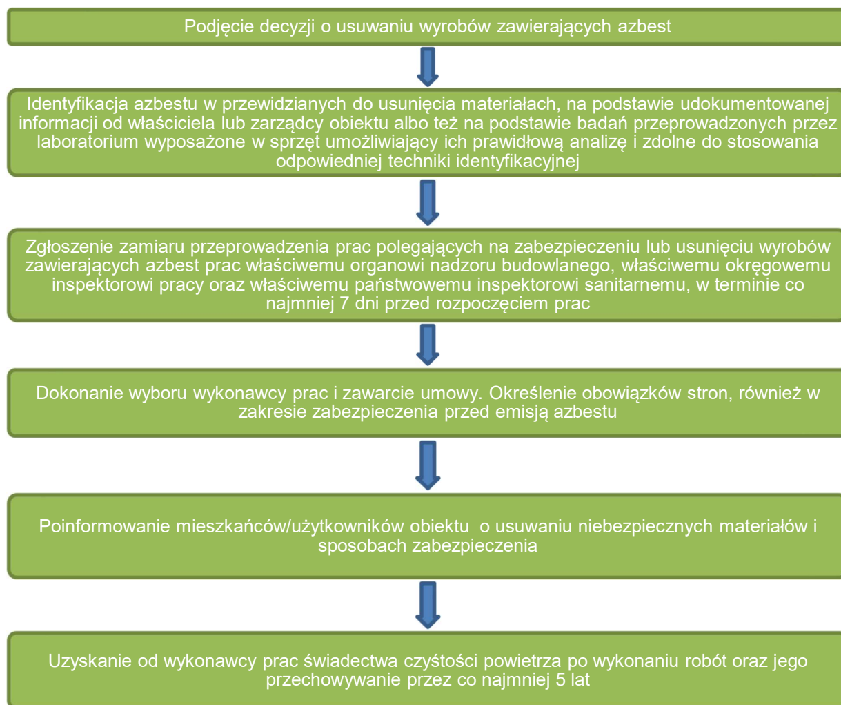
Rysunek 4. Schemat procedury dotyczącej obowiązków i postępowania właścicieli i zarządców przy usuwaniu wyrobów zawierających azbest z obiektów i terenów zlokalizowanych na terenie Gminy Myślenice.
